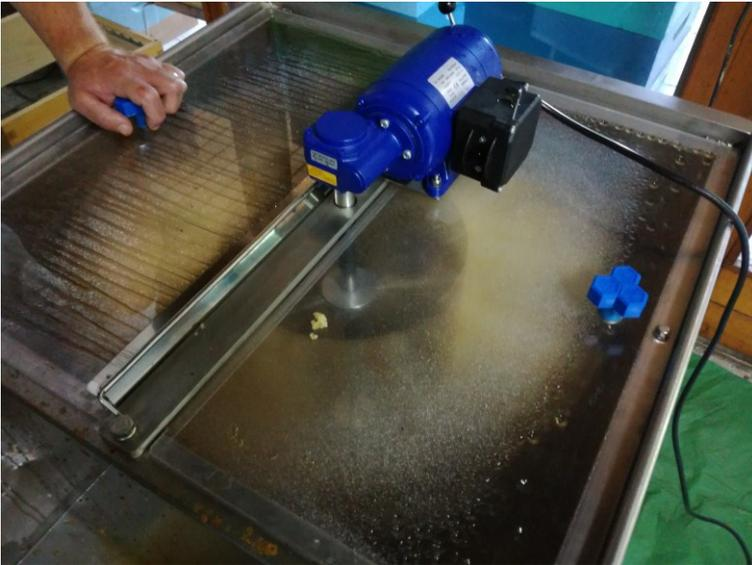
Les cadres de miel une fois désoperculés sont mis dans un extracteur automatique, et c'est par la force centrifuge que le miel s'écoule.
